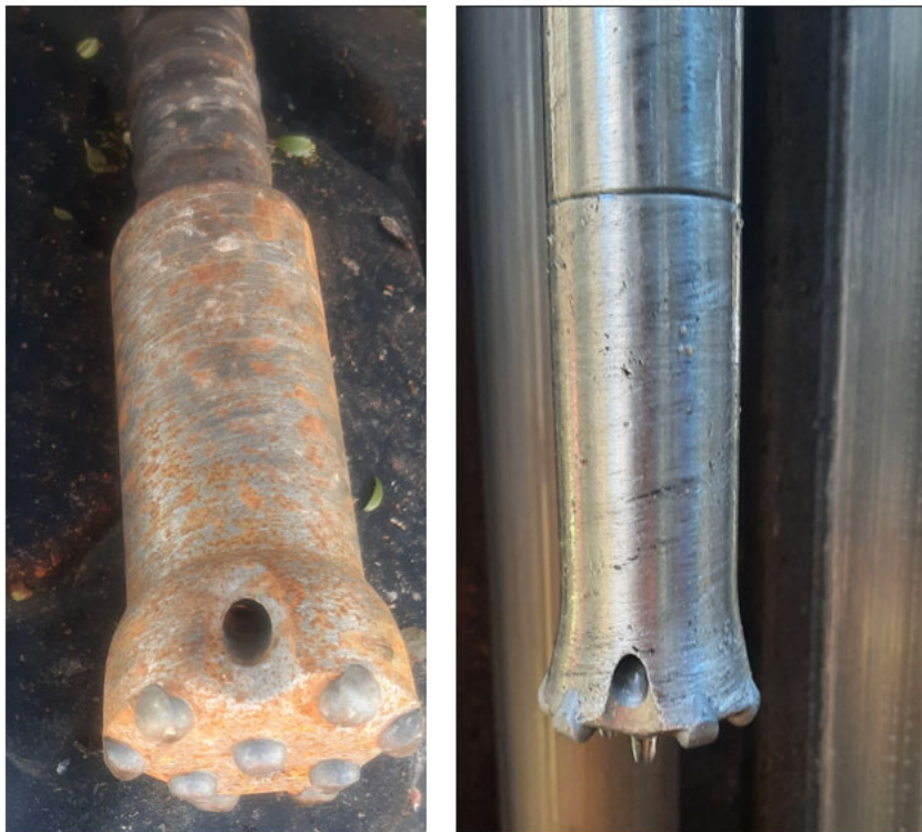
Figur 3 Bilde til venstre er borekrona som ble satt på borstanga for punkt 4, bilde til høyre viser samme borekrona etter endt boring.
