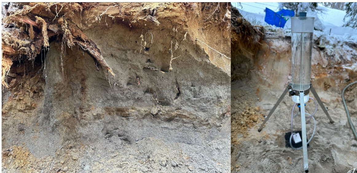
Figur 3-4: Bilder fra P2, der bildet til venstre viser nordre vegg i sjakta og bildet til høyre viser infiltrometeret installert i bunnen av sjakta på 1 m dybde.
