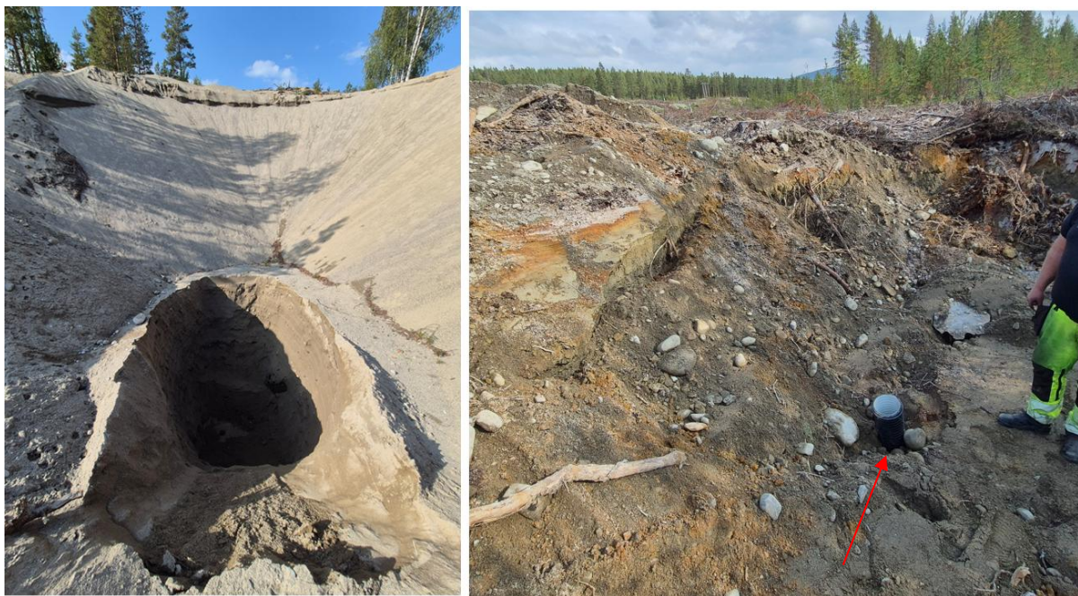
Figur 4.2: Bilder tatt ved befaringen 09.09.2025. Punkt 1 (venstre) og punkt 4 (høyre) ble gravd ut noen dager før befaringen. Et rør på ca. 4 meter er installert i bakken i punkt 4, vist med rød pil.
