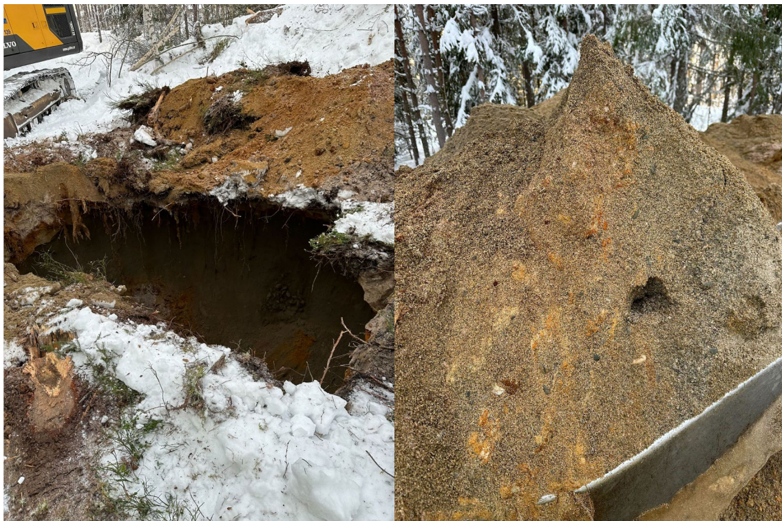
Figur 3-3: Bilder fra P1, der bildet til venstre viser sjakta med raste masser fra sidene og bildet til høyre viser de sandige massene 3-4 mut.
