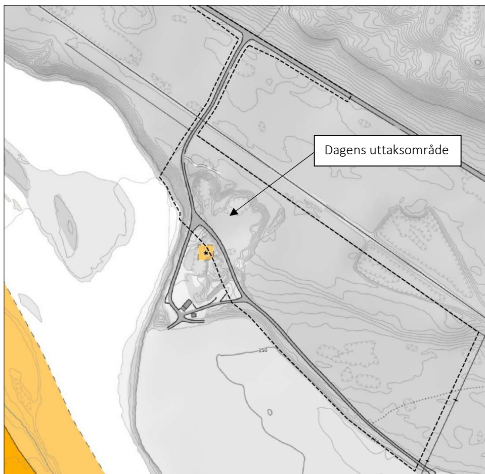
Figur 13: Utsnitt fra NGU's grus- og pukkdatabase, viser det registrerte sandtaket. Markeringen er feilplassert i forhold til dagens uttaksområde, som ligger på nordsiden av adkomstvegen.
