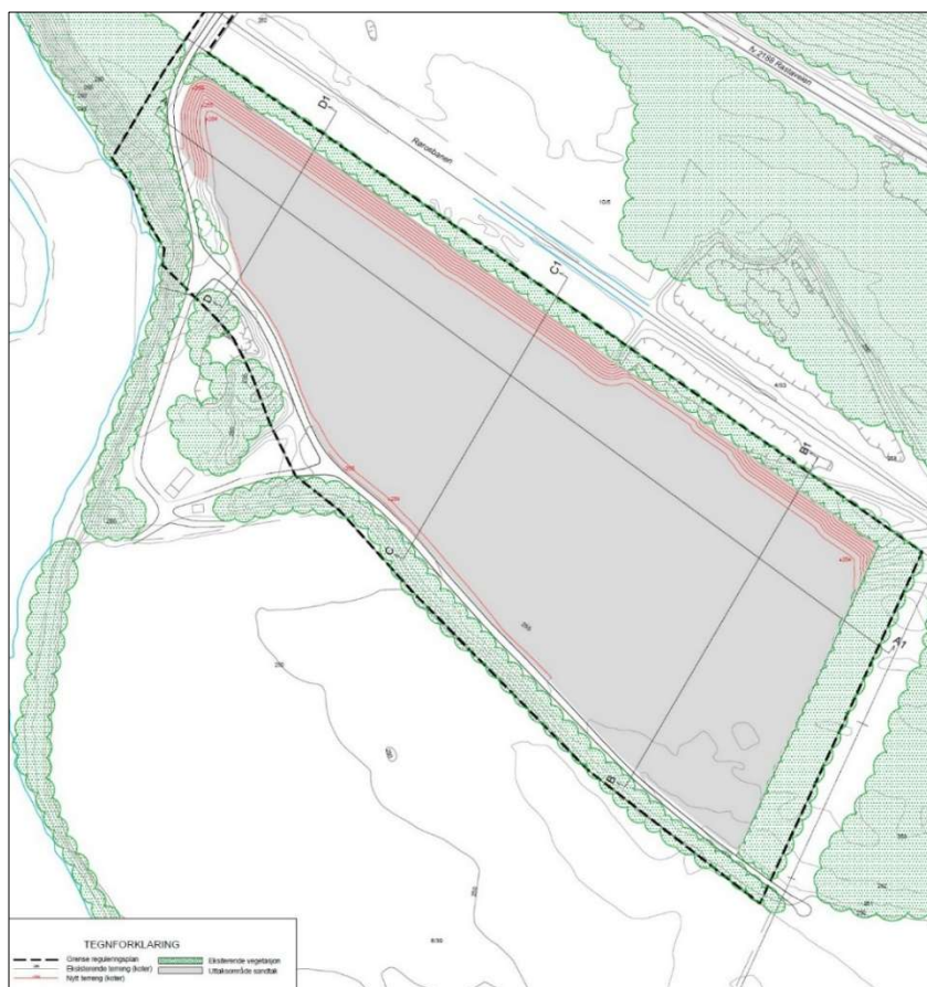
Figur 18: Utsnitt fra uttaksplan for Vollrusta sandtak, viser ferdig uttatt sandtak. Røde streker viser nye koter (nytt terreng) (Feste Nordøst as).
