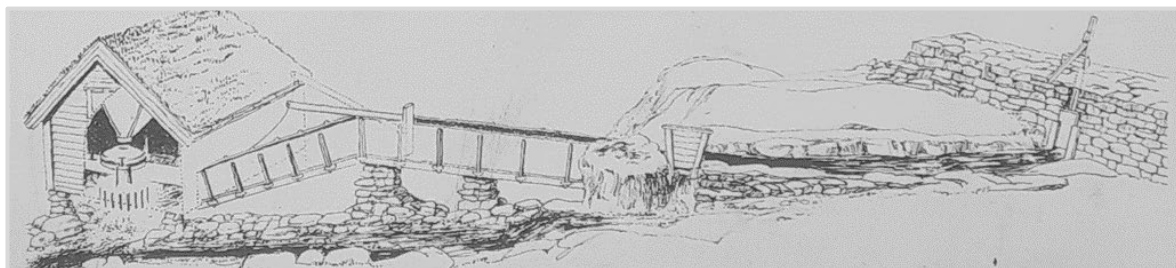
Figur 7.3: Prinsippskisse av hvordan vannet fra bekken ble ledet gjennom kverna for å drive kvernstenen.
