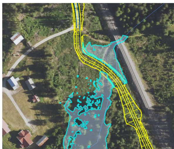
Figur 6-6 Oppstuvning/flomsone for Kvernbecken ved 25-årsflom i bekken.
